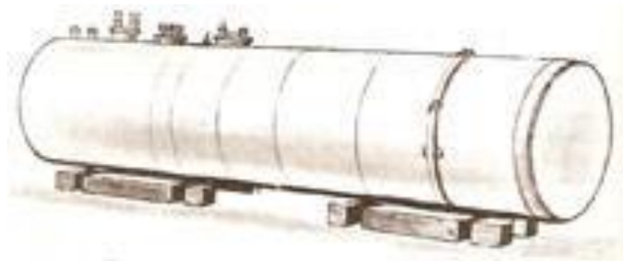
Алюминиевый передвижной резервуар на 100 м 3
