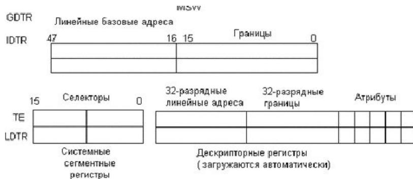
Разделением и объясняется присутствие в архитектуре микропроцессора следующих системных регистров: регистра таблицы глобальных дескрипторов **gdt** (Global Descriptor Table Register) имеющего размер 48 бит и содержащего 32-битовый (биты 16—47) базовый адрес глобальной дескрипторной таблицы **GDT** и 16-битовое (биты 0—15) значение предела, представляющее собой размер в байтах таблицы **GDT**;
