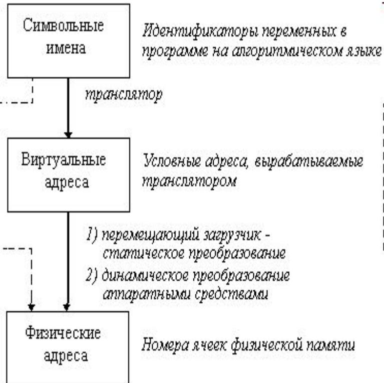
**Второй способ** заключается в том, что программа загружается в память в неизменном виде в виртуальных адресах, при этом операционная система фиксирует смещение действительного расположения программного кода относительно виртуального адресного пространства. Во время выполнения программы при каждом обращении к оперативной памяти выполняется преобразование виртуального адреса в физический.
