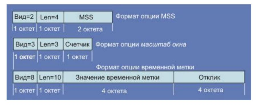
Размер поля *Опции* переменен и дополняется до кратного 32-бит с помощью поля *заполнитель*. В TCP определены следующие опции:
