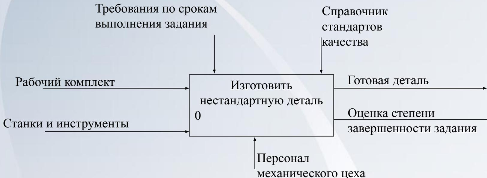
**Цель:** определить, какие функции должны быть включены в процесс изготовления нестандартной детали и как эти функции взаимосвязаны между собой.
