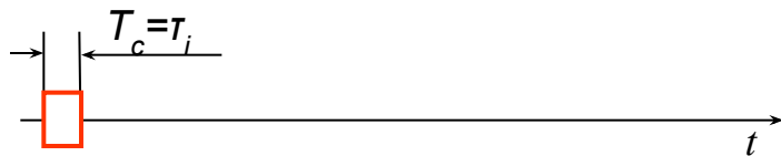
Одиночний радіоімпульс - відрізок гармонічного коливання з прямокутною обвідною
