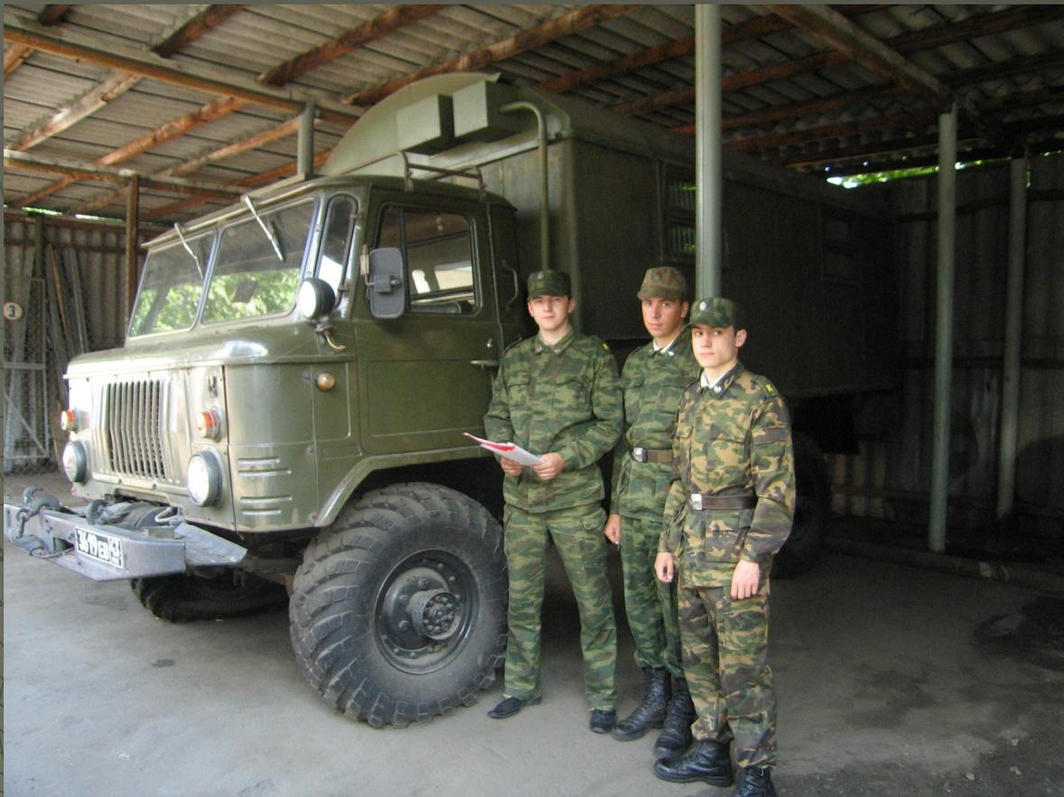
Кузов аппаратной П - 391 П представляет из себя деревянный фургон закрытого типа, брусково-каркасной конструкции. Материал наружной обшивки стен и крыши - металлический лист. Крыши и стены укреплены пенопластом. Материал остекления окон - сталинит (оргстекло). Окна аппаратной зарешечены и оборудованы светомаскировочными створками (материал штор - кирза двухслойная).
