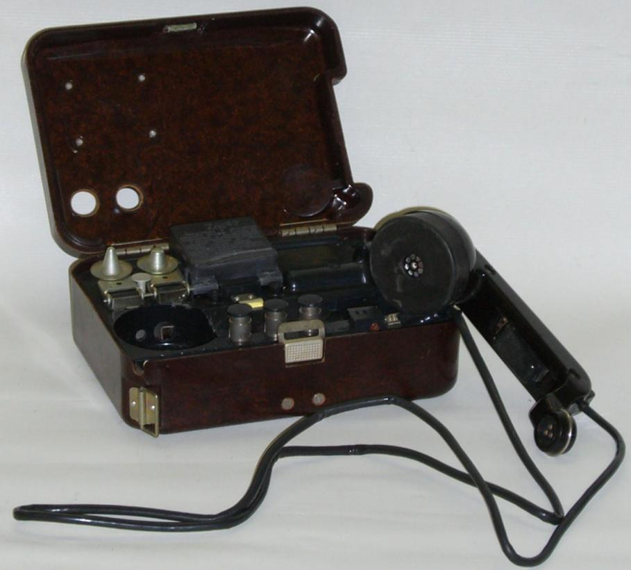
*Переговорное устройство* предназначено для служебной связи между кузовом аппаратной и кабиной водителя, а также для ведения служебной радиосвязи через радиостанцию Р-159. В устройство входят два щитка (ЩПУ) с гарнитурами: ЩПУ - 1 установлен в кабине, ЩПУ - 2 - в кузове. Связь между ними осуществляется кабелем. Устройство питается от щита питания напряжением 12В.
