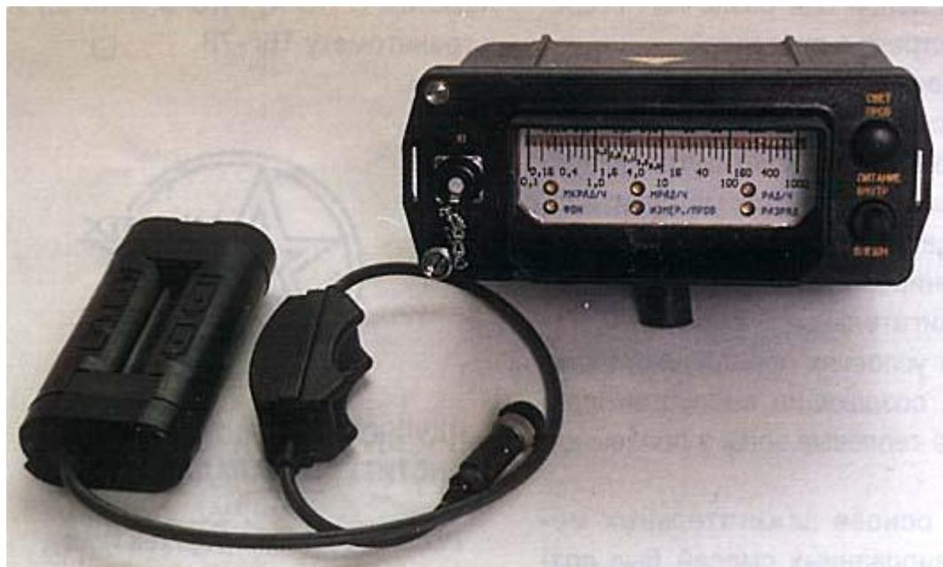
ИМД - обеспечивает измерение мощности поглощенной дозы гамма-излучения в диапазоне 10 мкрад/ч - 1000 рад/ч. Применяется в стационарных и носимых условиях, на летательных и подвижных объектах. Может использоваться для контроля за перемещением расщепляющихся материалов. Вес изделия - 1,6 кг.
