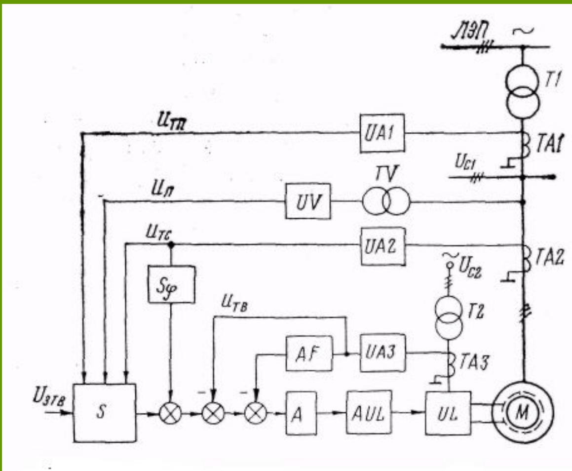
При ручном управлении СЭП обеспечивает пуск синхронного двигателя при полном (прямой) или пониженном (легкий или тяжелый) напряжениях на обмотке статора, с автоматической подачей возбуждения с контролем тока статора и форсировку возбуждения до  $1,75 I_{в\text{ ном}}$  при снижении напряжения питания двигателя до 15—20% от номинального значения,
