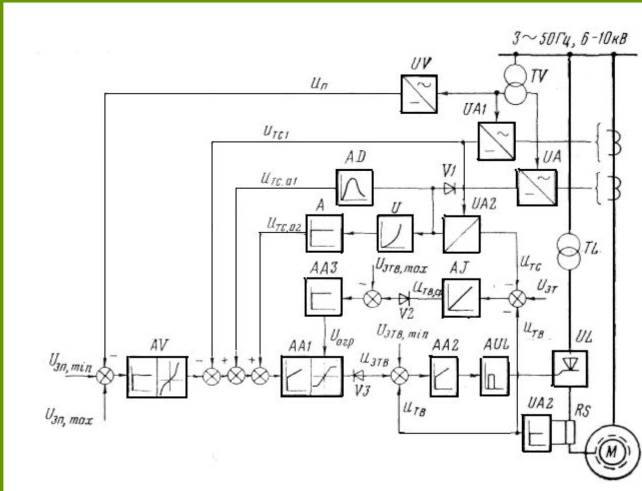
Для улучшения динамических режимов на регулятор АА1 дополнительно вводятся сигналы, пропорциональные производной  $u_{\text{та},1}$  и квадрату  $u_{\text{та},2}$  активной составляющей тока статора, обеспечивающие соответственно демпфирование колебаний ротора и форсировку тока возбуждения при набросе нагрузки на СД
