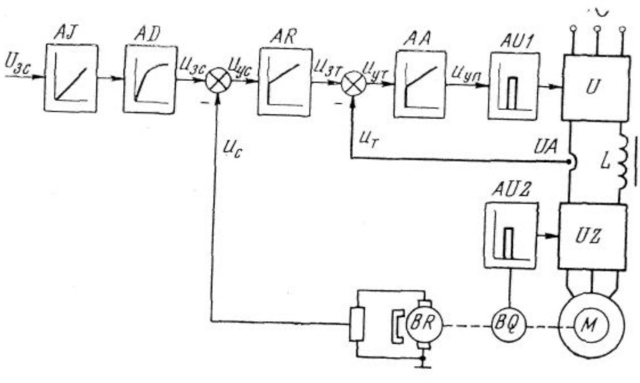
преобразователь частоты, кроме регулирования напряжения и частоты, выполняет роль электронного коммутатора (коллектора), осуществляющего переключение обмоток статора при повороте вала ротора на определенный угол
