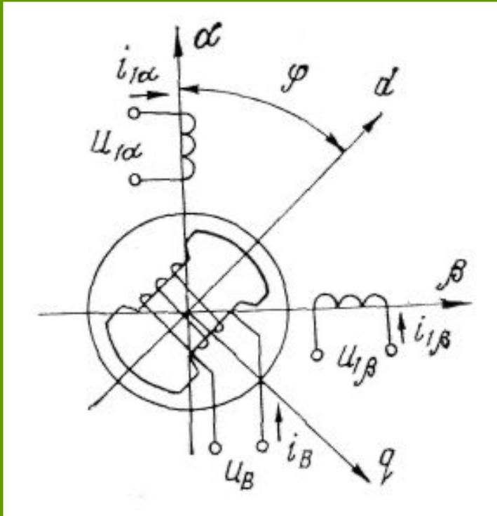
В СД ротор синхронно вращается с полем статора и при работе в двигательном режиме ротор отстает от поля статора на угол  $\Theta = \varphi_0 - \varphi$ , где  $\varphi_0 = \omega_0 t$  — угол, определяемый вращением поля статора, а  $\varphi = \omega t$  — вращением (положением) ротора.
