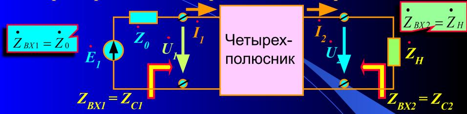
Режимом согласованного включения четырехполюсника называется такой режим его работы, когда *внутреннее сопротивление генераттора* выбрано равным характеристическому (собственному) сопротивлению четырехполюсника  $\mathbf{Z}_{c1}$ , а сопротивление нагрузки равным характеристическому сопротивлению  $\mathbf{Z}_{c2}$ .
