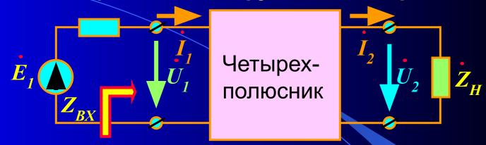
Входным сопротивлением четырехполюсника, нагруженного на сопротивление Z<sub>H</sub>, называется сопротивление со стороны входных зажимов при отключенном источнике
