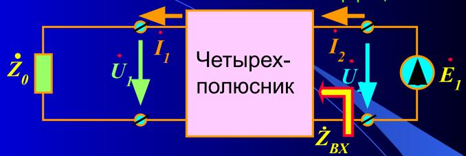
Выходным сопротивлением четырехполюсника, нагруженного на сопротивление **Z**<sub>0</sub>, называется сопротивление со стороны выходных зажимов при отключенном источнике
