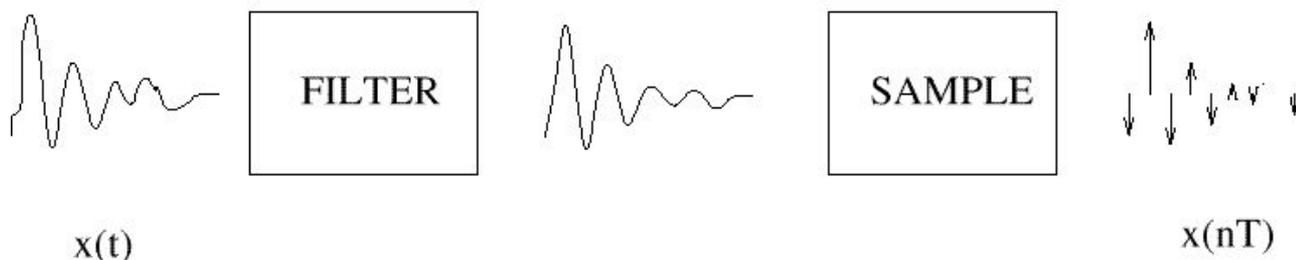
В телефонии использована частота дискретизации 8 кГц. 16 кГц обычно считается достаточным для распознавания и синтеза речи.
