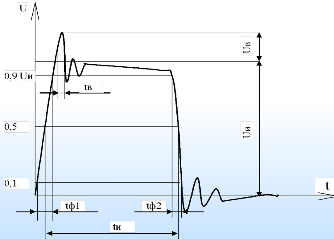
Типовая вид импульсного сигнала
