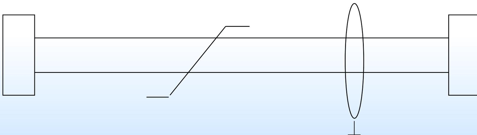
Типовая схема линии связи импульсными сигналами
