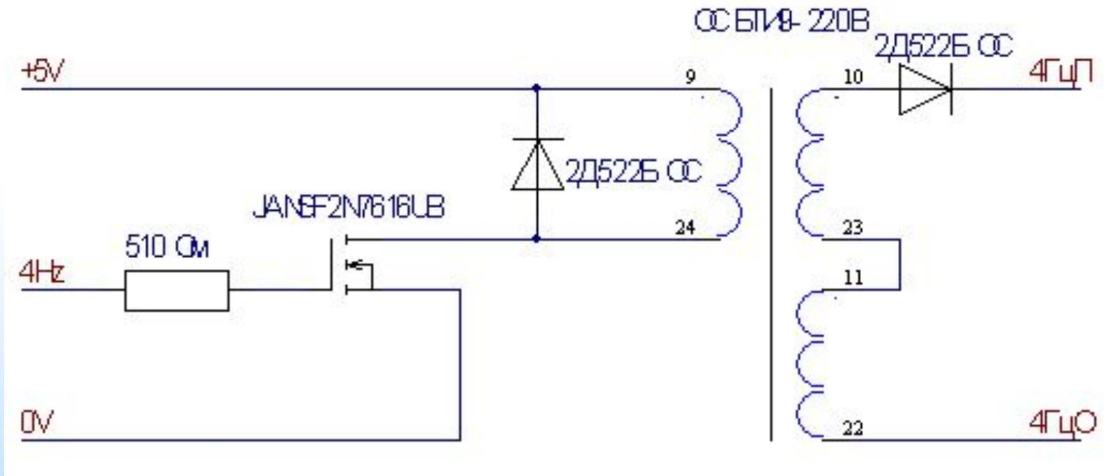
Типовая схема формирования импульсного сигнала
