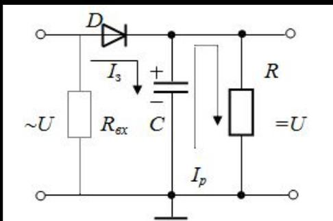
В установившемся режиме напряжение на катоде диода  $U_c \approx U_m$ , но из-за небольшого разряда конденсатора это напряжение немного уменьшается, и через диод проходят импульсы тока малой амплитуды, пополняя заряд конденсатора. Ток через диод течёт лишь в течение части периода, который характеризуется углом отсечки  $\Theta$
