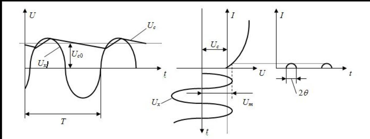
Конденсатор  $C$  заряжается до напряжения, определяемого суммарным воздействием постоянной и переменной составляющих напряжения, которое подводится к преобразователю, то есть до пикового значения  $U_m = U'_m + U_0$ .
