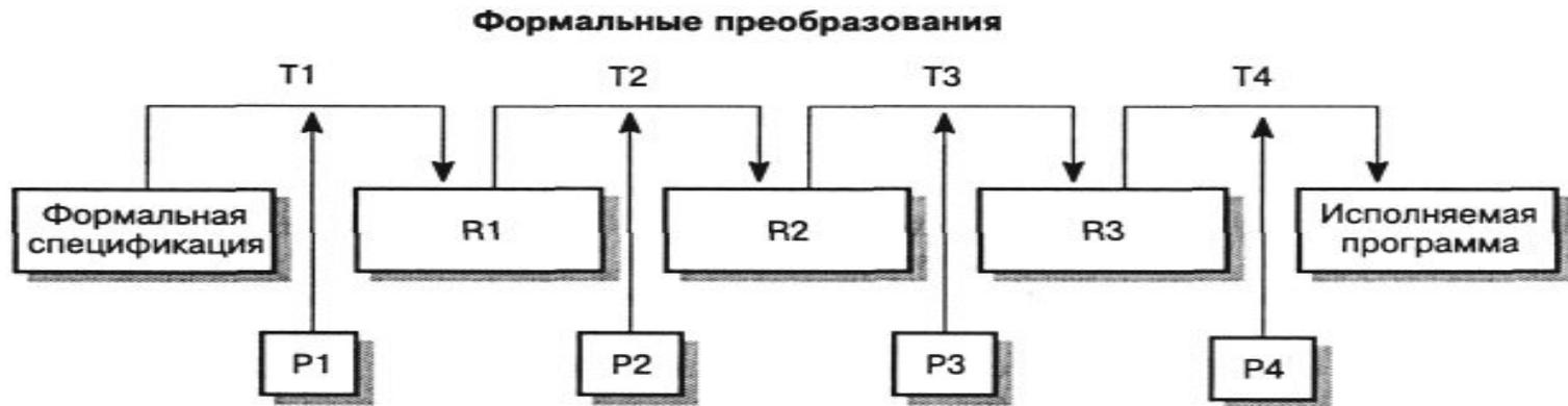
В процессе преобразования формальное математическое представление системы последовательно трансформируется в программный код, постепенно все более детализированный. Преобразования выполняются математически корректно и проверка соответствия спецификации и программы не требуется.
