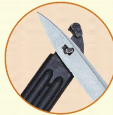
Пример соединения штык-ножа и ножен для резки колючей проволоки
