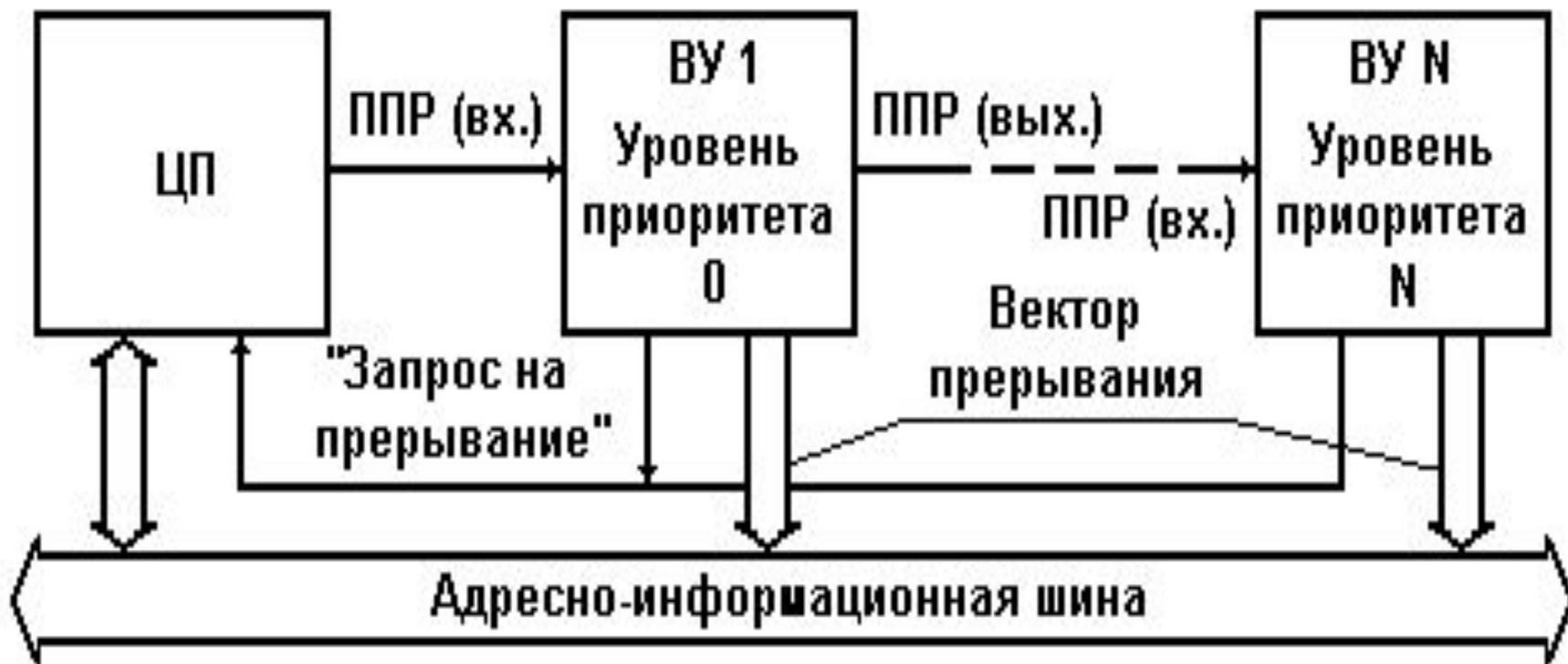
Вектор прерывания выдается контроллером не одновременно с запросом на прерывание, а только по разрешению процессора.
