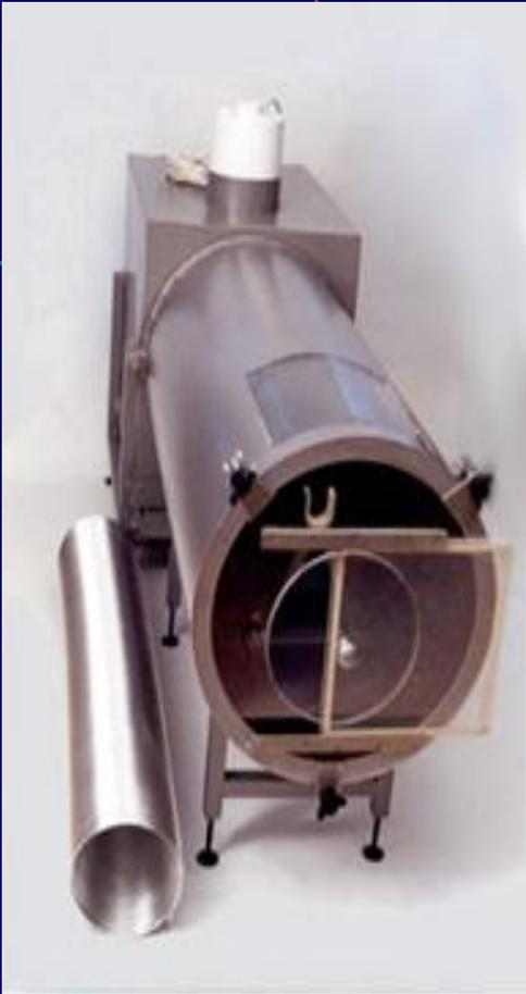
Установка предназначена для обеспечения безопасности и санитарных норм при проведении испытаний газового и сигнального оружия.
