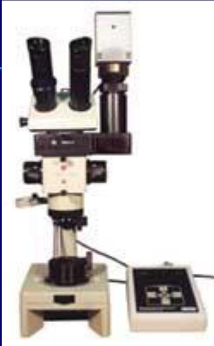
Видеоприставка к микроскопу **МБС-10**, который активно используется в экспертно-криминалистических подразделениях, существенно упрощает и облегчает работу эксперта по исследованию различных следов. Видеоприставка состоит из трех узлов: цветной видеокамеры, устанавливаемой на микрофотографическое устройство, осветительного блока и устройства управления осветительным блоком. Для повышения разрешающей способности системы может быть применен оригинальный видеокорректор.
