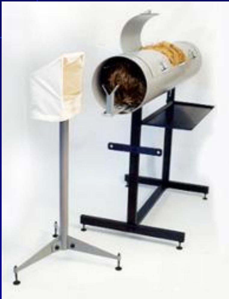
Пулегильзоуловитель предназначен для проведения контрольного отстрела нарезного стрелкового оружия с целью получения следообразующих деталей оружия на пулях и гильзах.
