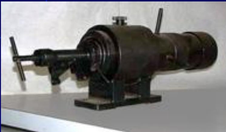
Устройство предназначено для проверки отечественных и зарубежных боеприпасов калибров 12,7-15 мм на пригодность к стрельбе при проведении криминалистических экспертиз. Устройство аналогично предыдущему с той лишь разницей, что в нем отстрел боеприпасов производится только дистанционно. Устройство имеет ударно-спусковой механизм, предназначенный для боеприпасов центрального боя с капсюлем ударного воспламенения.
