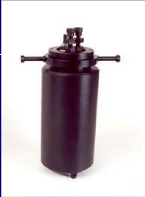
Взрывная камера «ВК-2» предназначена для многократного безопасного уничтожения методом подрыва небольших взрывных устройств с тротиловым эквивалентом до 2,0 г.
