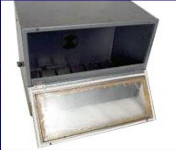
Предназначена для выявления и фиксации следов рук на малогабаритных предметах, в том числе короткоствольном огнестрельном оружии, посуде, и т. д. Камера содержит приспособления для размещения в ней одновременно пяти объектов и позволяет проводить процесс окуривания как при использовании цианоакрилатового геля в пластиковой упаковке ("конвертах"), так и с применением окуривателя.
