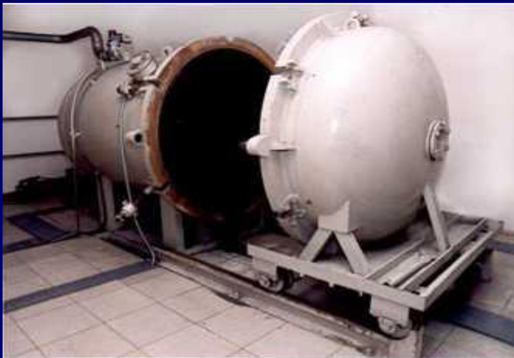
Комплекс предназначен для проведения многократных испытаний и уничтожения взрывчатых веществ (ВВ), средств инициирования ВВ и взрывных устройств с максимально допустимой массой ВВ до 1000 граммов в тротиловом эквиваленте. Допускается подрыв осколочных боеприпасов с массой ВВ до 200 г в тротиловом эквиваленте.
