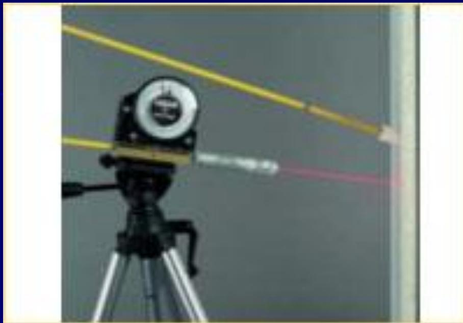
Мощный лазерный яркий луч указателя траектории позволяет точно установить траекторию пули.
