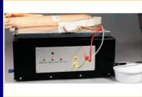
Электростатические устройства применяются для снятия пылевых следов на полу, бумаге, поверхности стола и пр. Частицы пыли в электростатическом поле притягиваются к тёмно окрашенной плёнке съёмника, в результате след просто сфотографировать и идентифицировать.
