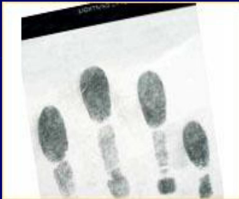
Следокопирующие плёнки при использовании удерживаются за чёрную полосу вверху. След копируется на адгезивный слой, после чего плёнка крепится на подложку нужного цвета и размера. Полоска отделяет Ваши пальцы от адгезивной поверхности, надпись на полоске указывает, с какой стороны следует исследовать скопированный след, за полосу удобно снимать плёнку с поверхности.
