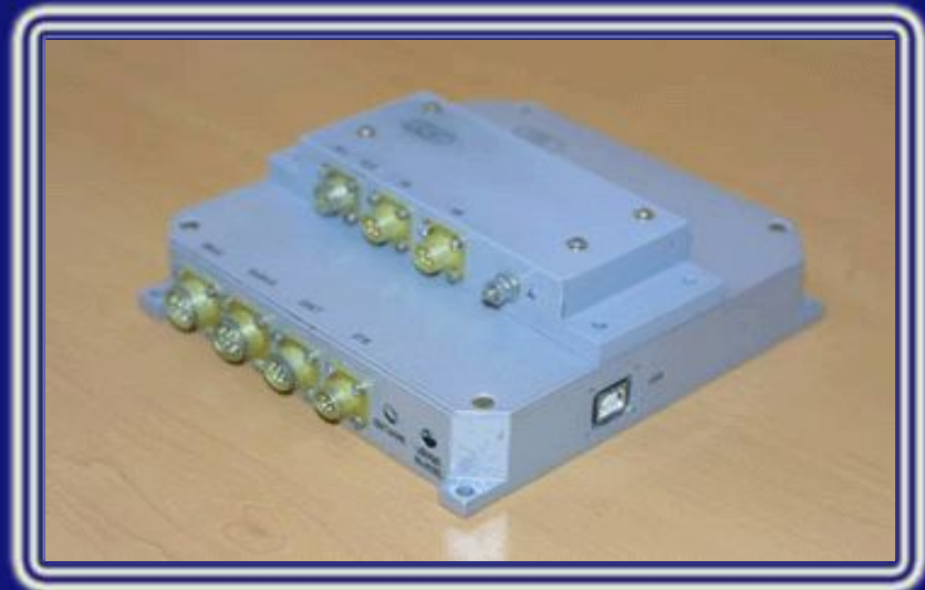
Внешний вид накопительного устройства и сетевого кондиционера
