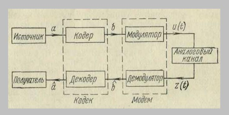
В системах передачи дискретных сообщений принято различать две группы устройств: кодеки и модемы.
