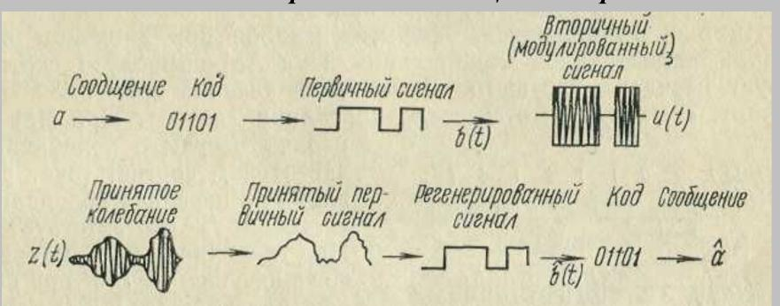
При передаче непрерывного сообщения оно сначала преобразуется в первичный электрический сигнал, а затем, как правило, с помощью модулятора формируется сигнал, который и посылается в линию связи. Принятое колебание подвергается обратным преобразованиям, в результате которых выделяется первичный сигнал. По нему затем восстанавливается с той или иной точностью сообщение.
