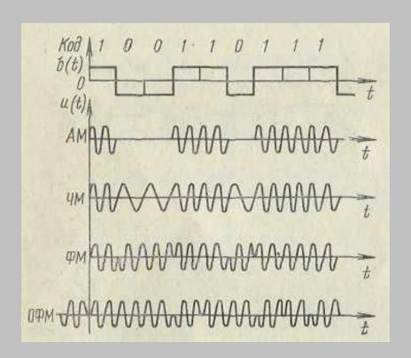
Наконец, на практике нашла применение система **относительной фазовой модуляции** (ОФМ). В отличие от ФМ, при ОФМ фаза сигналов отсчитывается не от некоторого эталона, а от фазы предыдущего элемента сигнала. В двоичном случае символ 0 передается отрезком синусоиды с начальной фазой предшествующего элемента сигнала, а символ 1 — таким же отрезком с начальной фазой, отличающейся от начальной фазы предшествующего элемента сигнала на  $\pi$ .
