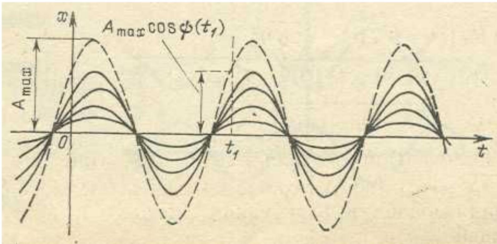
$$w(x; t_1) = 1/A_{max} \cos \psi(t_1), \quad 0 < x < A_{max} \cos \psi(t_1).$$
