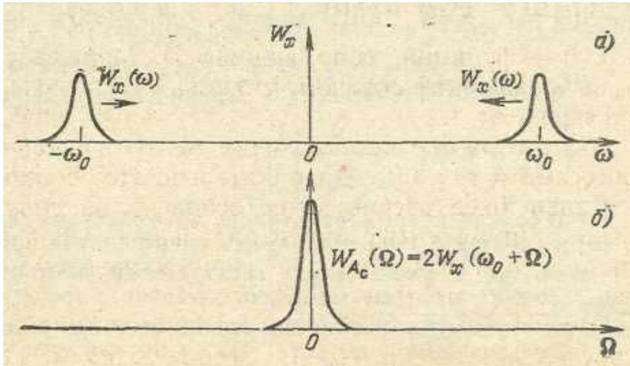
Спектры: а) узкополосного процесса с центральной частотой  $\omega_0$ ;
