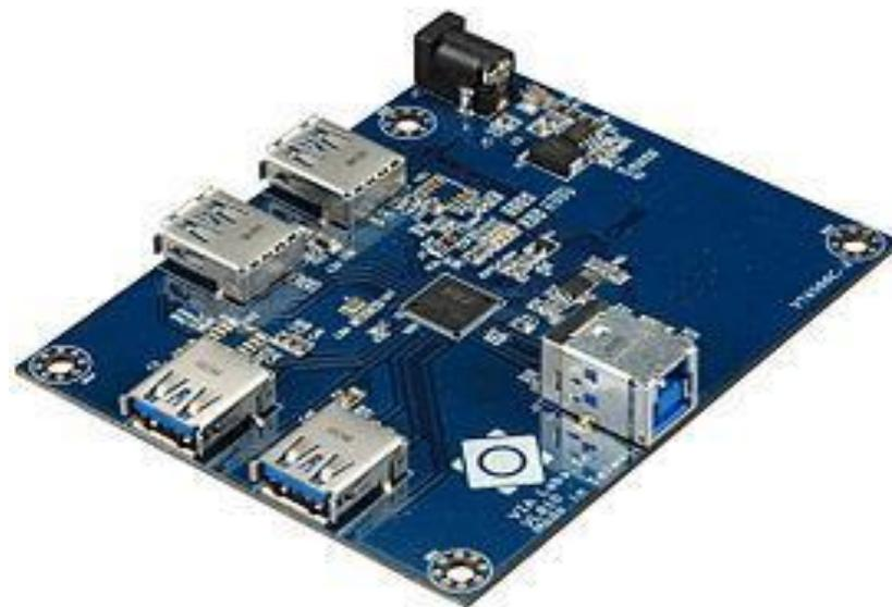
USB 3.0 хаб, демонстрационная плата на базе микросхемы VL810 фирмы VIA
