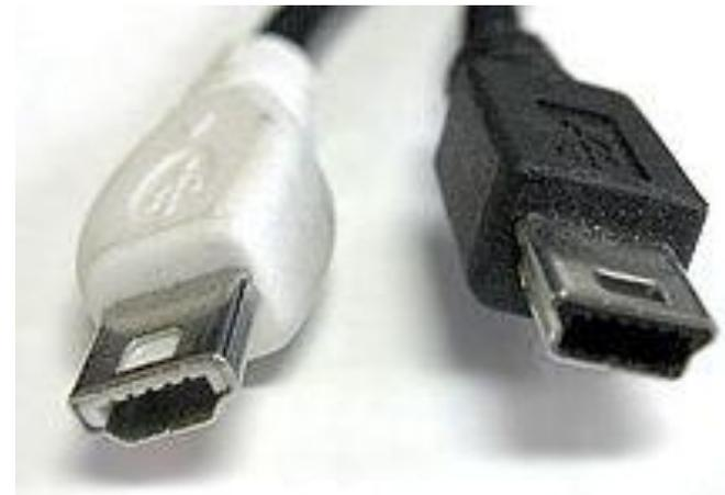
Mini USB Тип А (слева) и Mini USB Тип В (справа)
