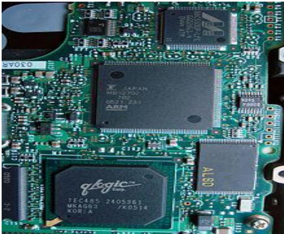
СБИС контроллера на плате управления жёстким диском Fujitsu MAP3735NC
