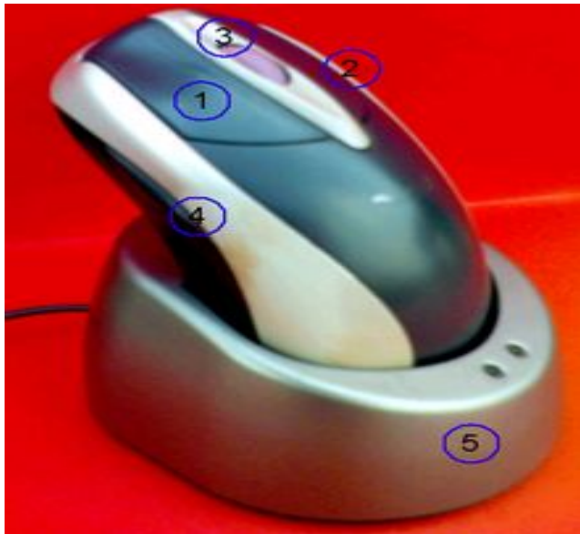
Беспроводная мышь на подзарядке (4 — мышь, 5 — док-станция)
