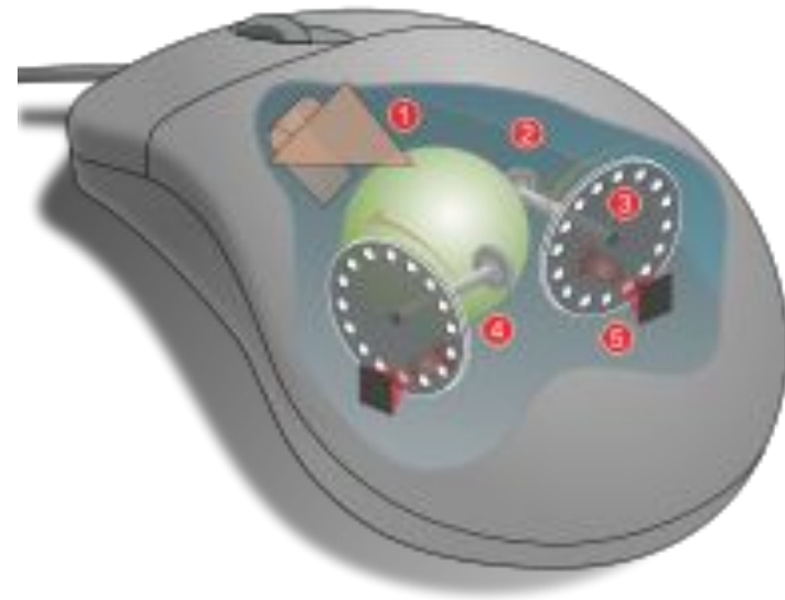
Оптопарный координатный датчик в мыши с шаровым приводом
