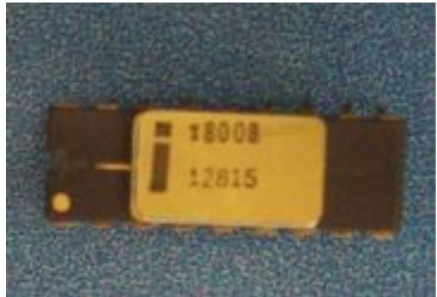
Первоначально эти микропроцессоры использовались только электронщиками-любителями и в различных специализированных устройствах. Но в 1974 г. несколько фирм объявили о создании на основе микропроцессора Intel-8008 компьютера, т.е. устройства, выполняющего те же функции, что и большая ЭВМ. В начале 1975 г. появился первый коммерчески распространяемый компьютер Альтаир-8800, построенный на основе микропроцессора
