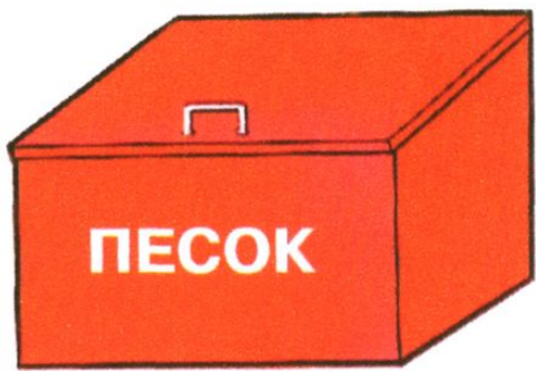
ЯЩИК ДЛЯ ПЕСКА должен иметь вместимость 0,5; 1,0 или 3 м 3 и комплектоваться совковой лопатой (ГОСТ 3620-76)
