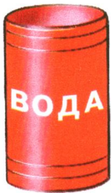
РЕЗЕРВУАР ДЛЯ ВОДЫ (ГОСТ 12.4.009-83) должен быть объемом не менее 0,2 м 3 и комплектоваться ведрами
