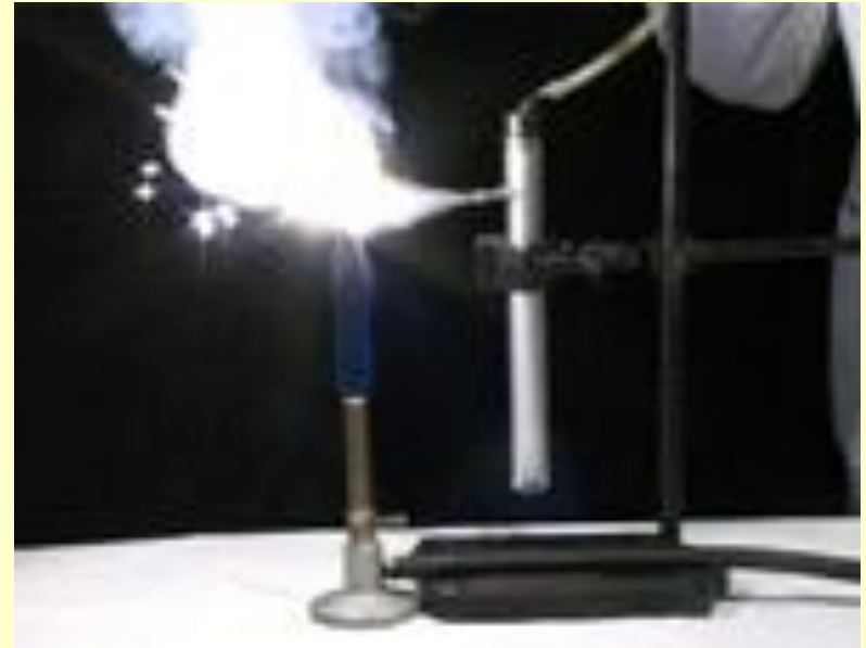
Распыление порошка алюминия над горелкой
