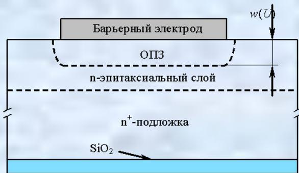
Поперечное сечение контакта МП на n-n<sup>+</sup> структуре со слоем SiO<sub>2</sub> на обратной стороне подложки
