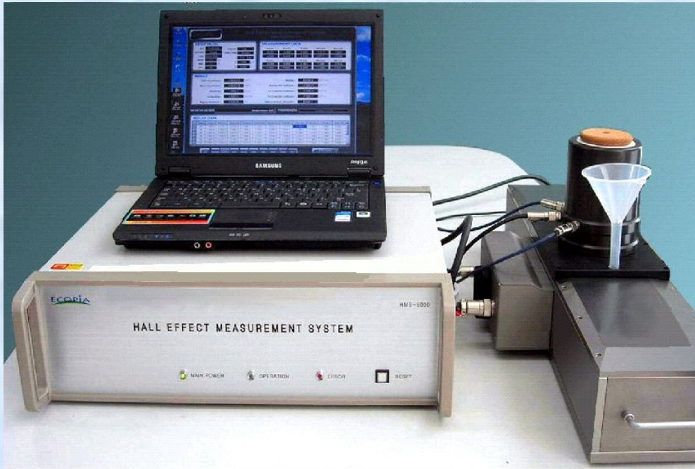
Устройство крепления образца с охлаждающим резервуаром
