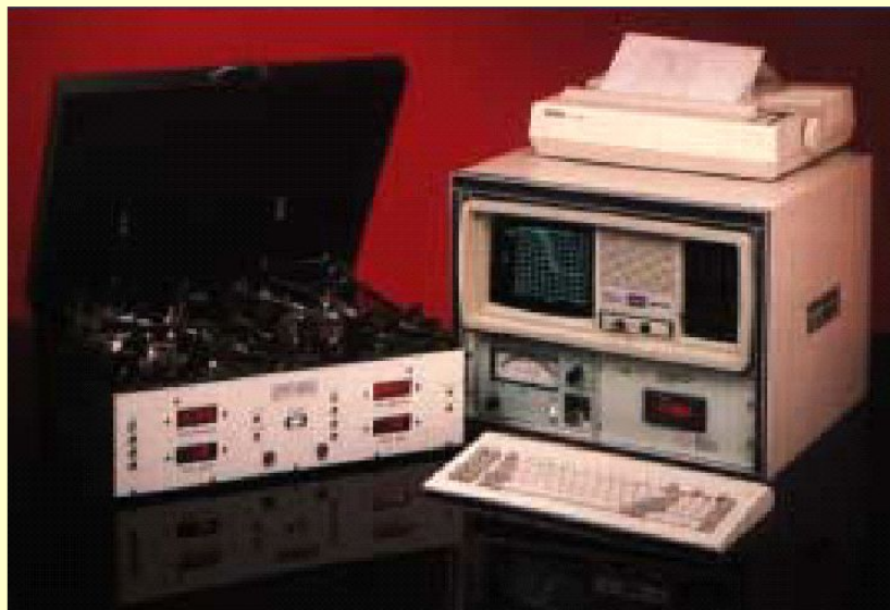
Рис.24 MDC Model 8512 «DuoChuck» с измерителем ВФХ
