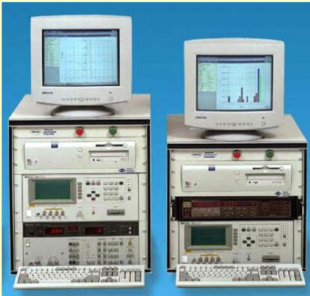
Автоматизированные C-V измерительные системы фирмы MDC на базе L,C,R измерителя Agilent 4284A
