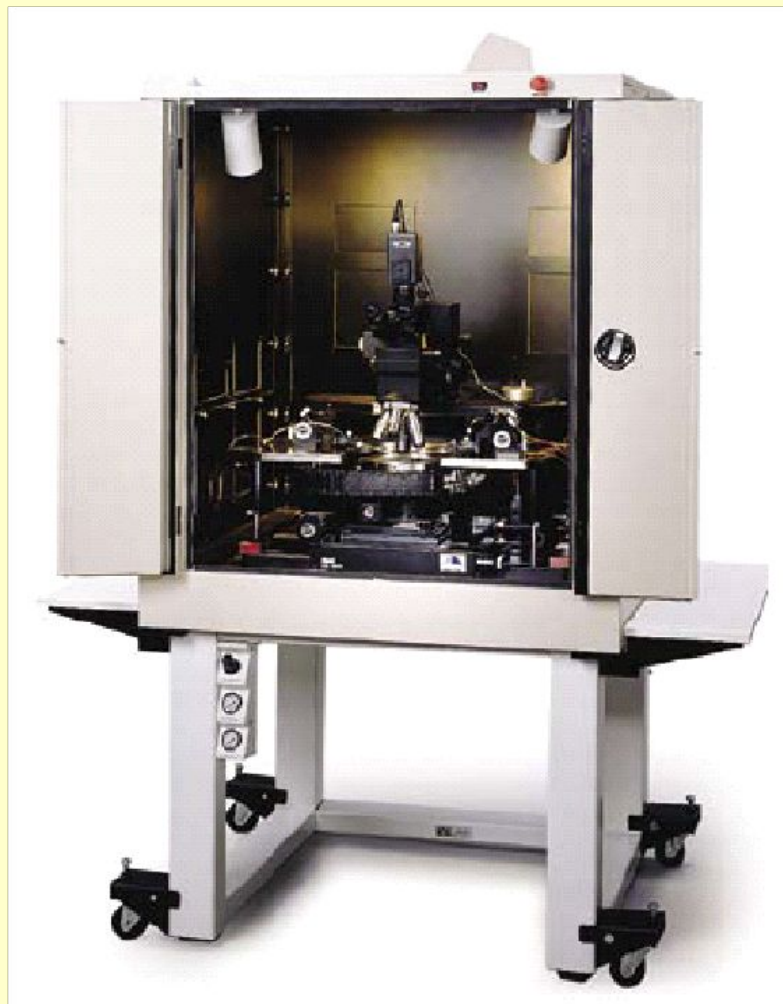
Измерительная камера с зондовой установкой фирмы Cascade Microtech для измерения в темновых условиях
