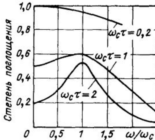
Поглощение при циклотронном резонансе в зависимости от напряженности постоянного магнитного поля (в единицах  $\omega/\omega_c$ )
