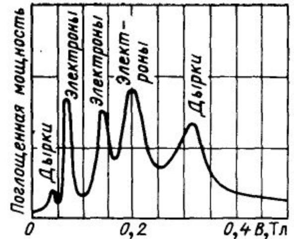
Поглощение при циклотронном резонансе в германии ( $B$  — индукция)
