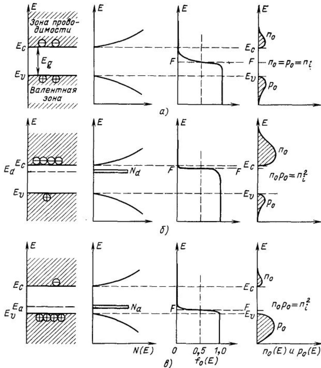
Зонная диаграмма, плотность состояний, распределение Ферми—Дирака и концентрация носителей заряда в собственном (а), донорном (б) и акцепторном (в) полупроводниках при термодинамическом равновесии
