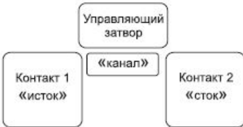
Принципиальная схема транзисторной структуры с управляющим затвором
