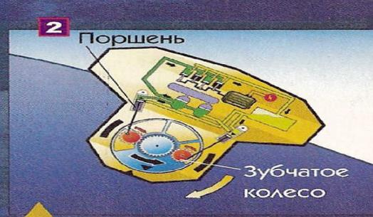
Крен корпуса приводит, в свою очередь, к тому, что колесо-маятник начинает вращаться. Под действием собственного веса маятник качается внутри корпуса. При этом колесо приводит в движение (через систему шестеренок) шатуны, а те заставляют двигаться поршни. Поршень в левом цилиндре поднимается, а в правом, наоборот, опускается.
