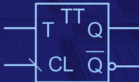
T-триггер с управлением по **срезу** (отрицательному фронту) тактового сигнала
