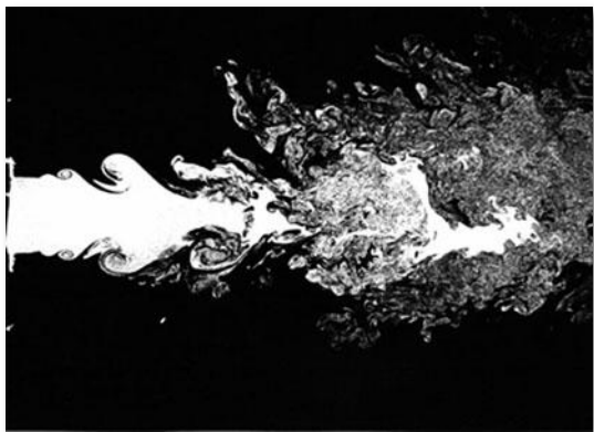
Неустойчивость струи жидкости в другой жидкости
