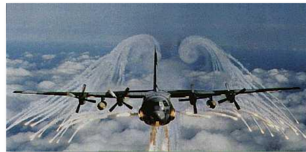
Образование вихревой структуры при обтекании крыла
