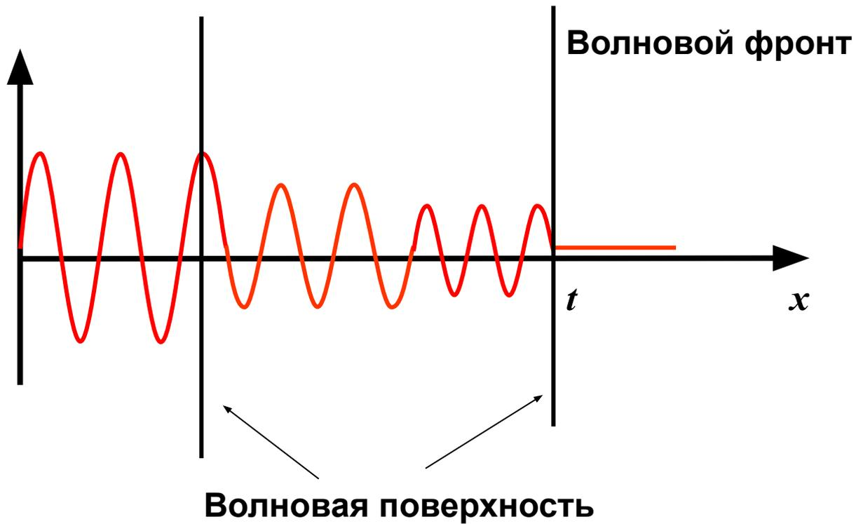
*Геометрическое место точек, колеблющихся в одинаковой фазе, образует поверхность одинаковой фазы, или волновую поверхность.*
