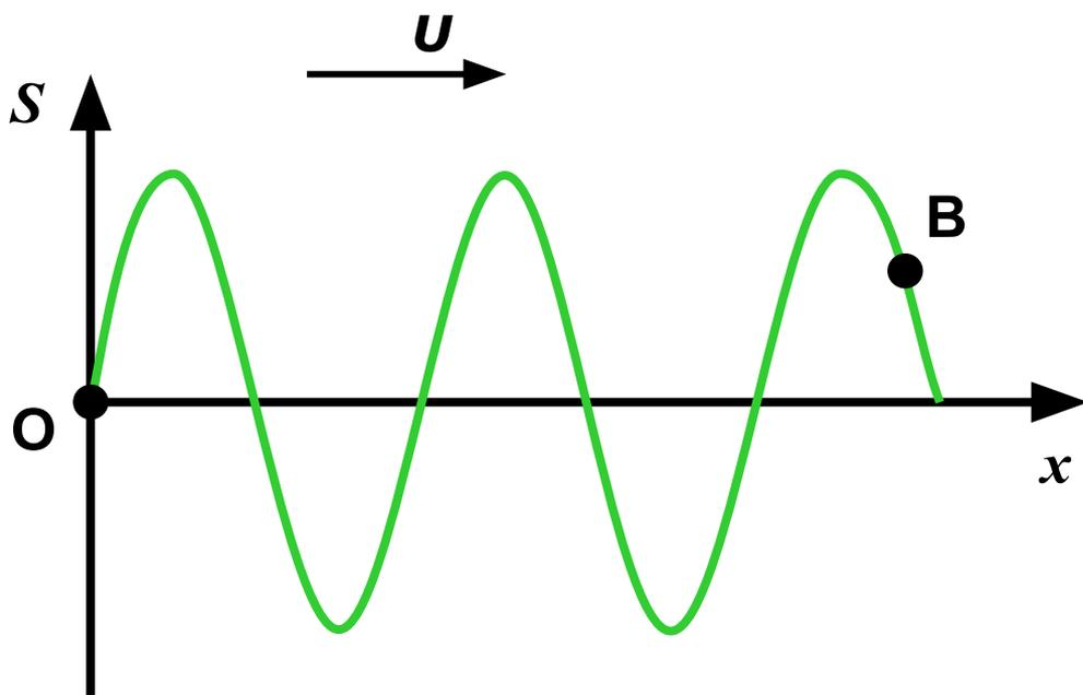
*График зависимости  $S(x, t)$  в определенный момент времени называется формой возмущения.*
