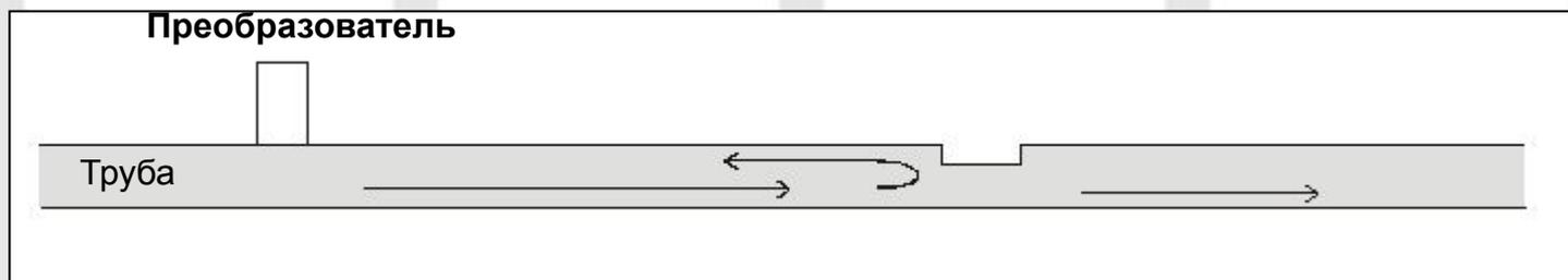
**В данной системе используются два типа волн, способных распространяться вдоль труб – сдвиговая (волна кручения), или продольная волна сжатия-разряжения.**
