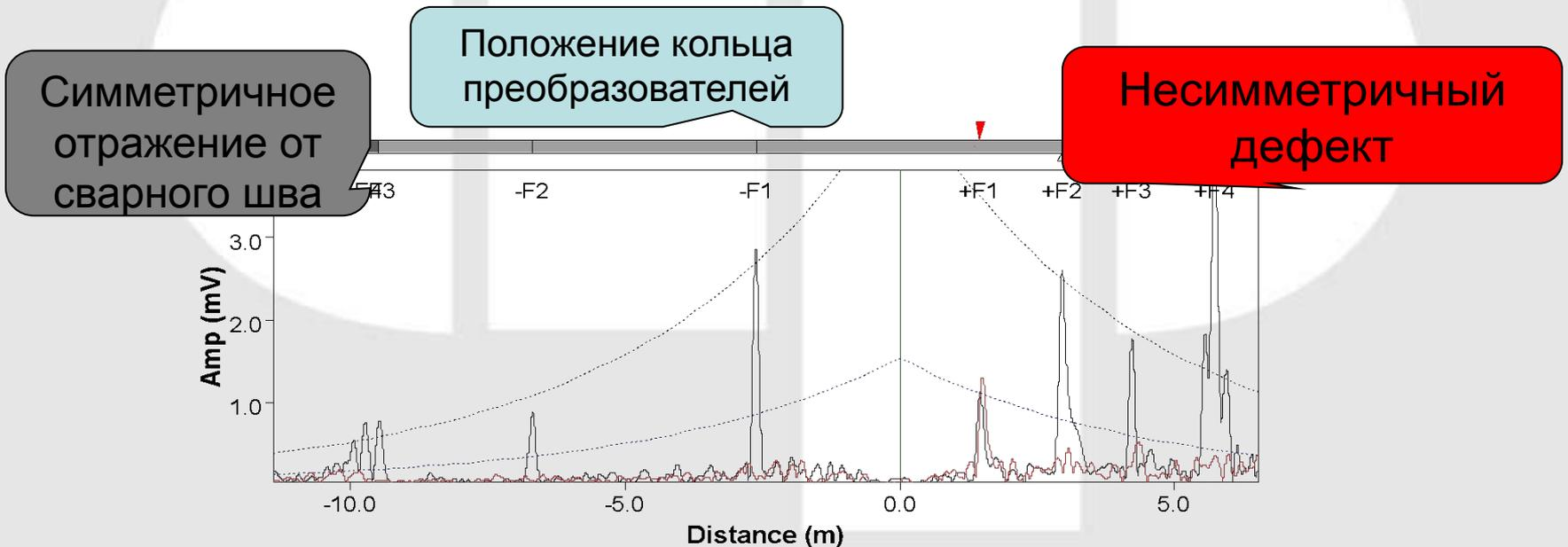
Отражения от симметричных дефектов регистрируются как осесимметричные волны. Несимметричные отражения имеют существенно меньшую амплитуду. Примером может служить сварной шов.
