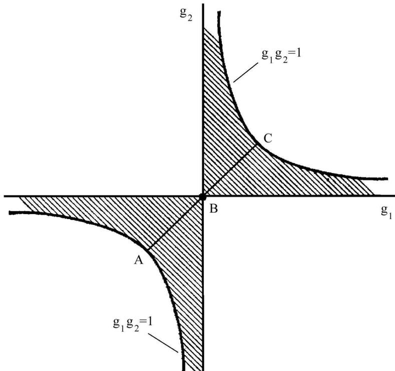
Область устойчивых резонаторов заштрихована. Границы заштрихованной области соответствуют неустойчивым резонаторам.
