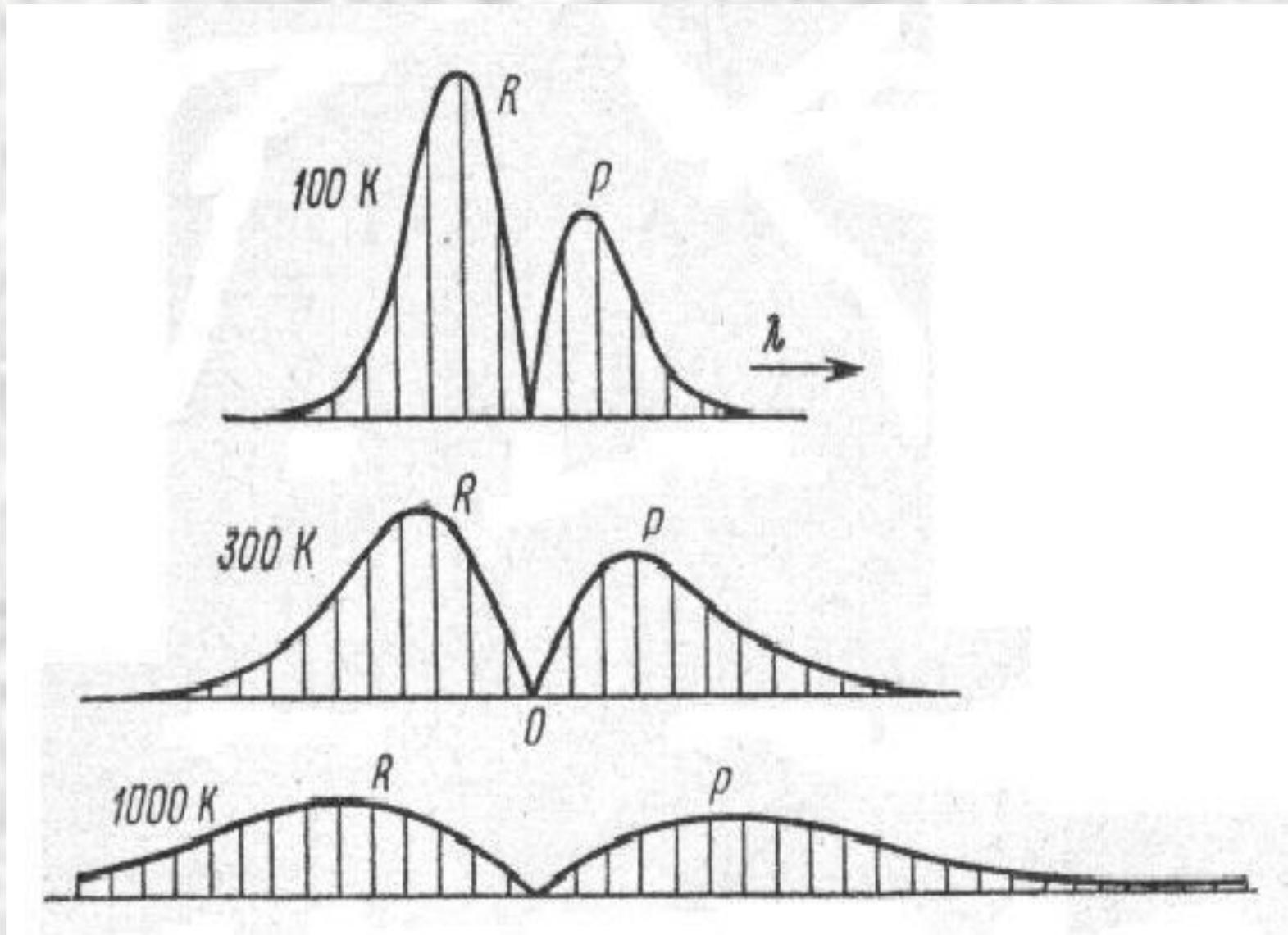
**Распределение частот и интенсивностей в спектре излучения при различных температурах**
