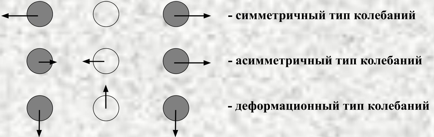
Деформационные колебания могут происходить как в одной, так и в двух взаимно-перпендикулярных плоскостях, вследствие чего данный тип колебаний имеет две моды:  $l=0, 1$
