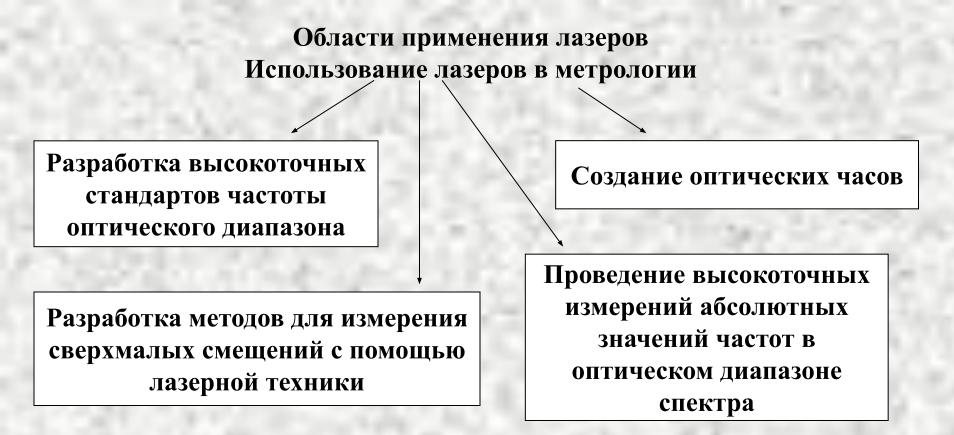
Физической основой этих разработок является способность фемтосекундных лазеров с синхронизацией мод генерировать широкий спектр эквидистантных частот, интервал между которыми может быть стабилизирован путем фазовой привязки частоты межмодовых биений к частоте внешнего высокостабильного генерат
