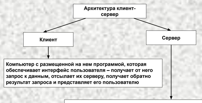
Сервер - основная структура, обеспечивающая функции управления данными. На сервере физически хранятся программы обработки данных- хранимые процедуры, Запросы - хранимые команды, БД или ее часть
