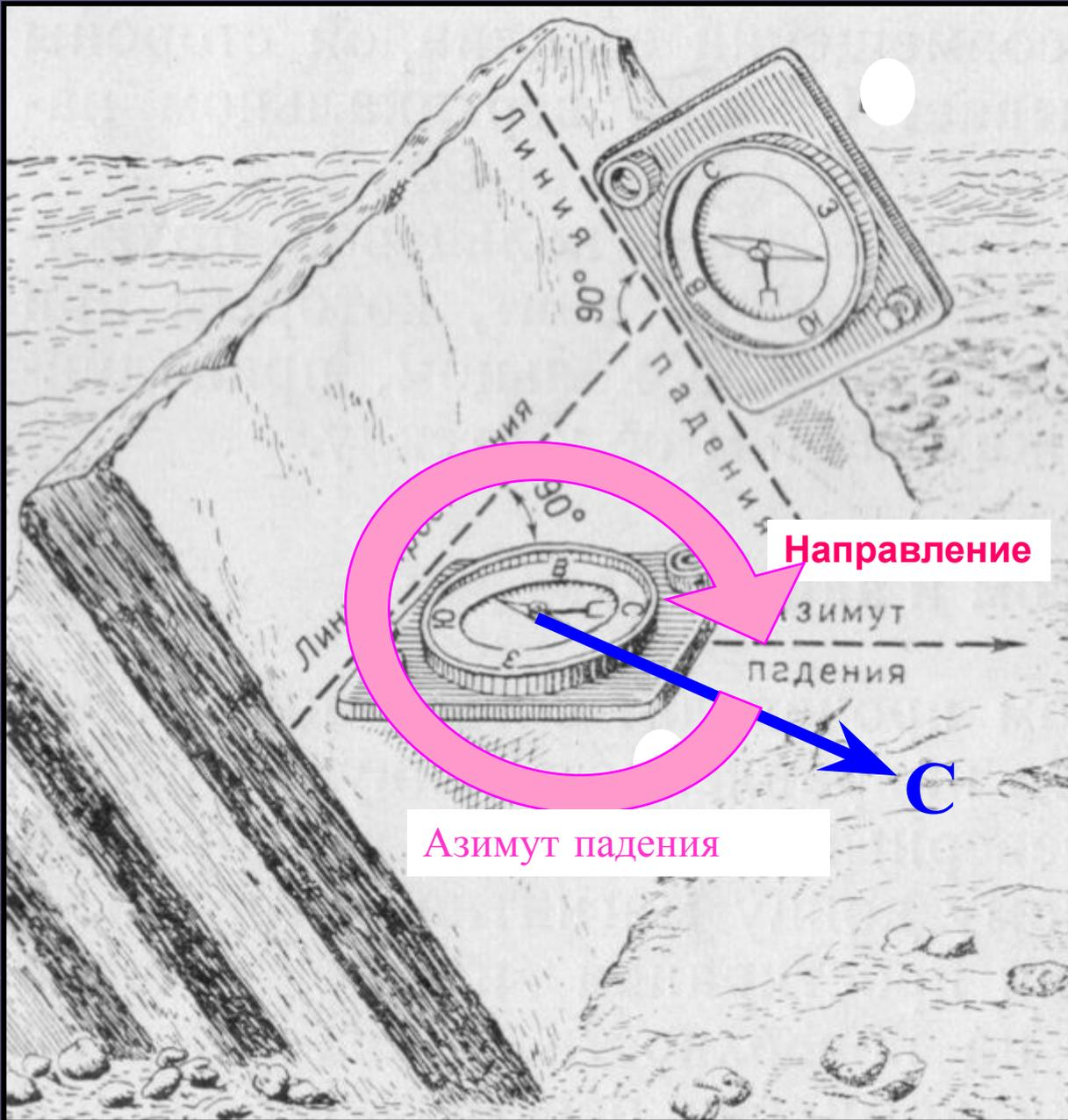
1. Чтобы измерить азимут падения слоя, надо, держа компас горизонтально (контроль по уровню), приложить его короткой стороной к линии простирания, направив северным концом по направлению падения пласта и взять отсчет по северному концу стрелки.
