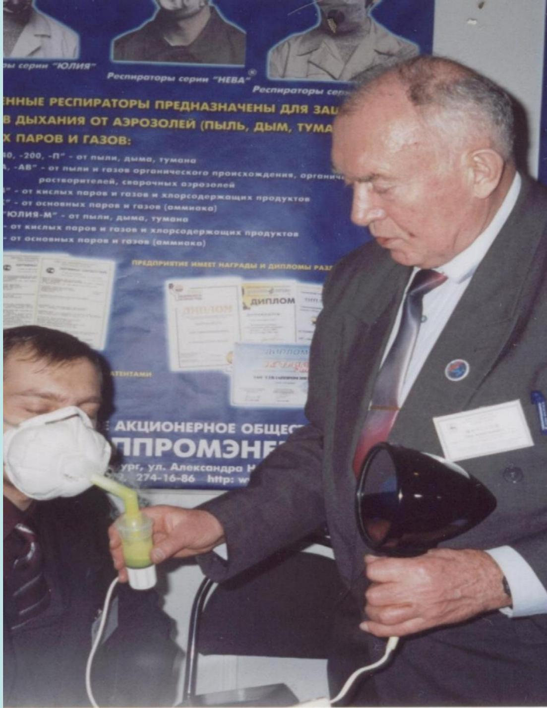
Изучение подсоса по полосе обтюрации СИЗ Од с помощью люминесцирующих аэрозолей на установке «ИНГАВИТ»
