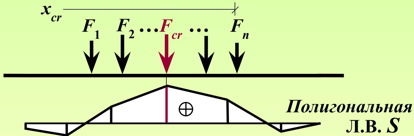
Груз, при расположении которого **над вершиной линии влияния** фактора  $S$  значение  $S$  от действия системы параллельных сосредоточенных грузов становится экстремальным ( $S_{\max}$  или  $S_{\min}$ ), называется **критическим грузом**.
