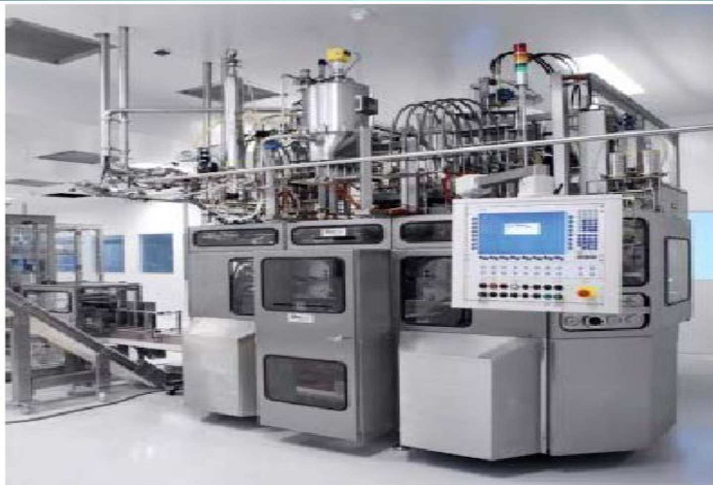
Установка розлива в бутылки инфузионных растворов по технологии: Blow-Fill-Seal
