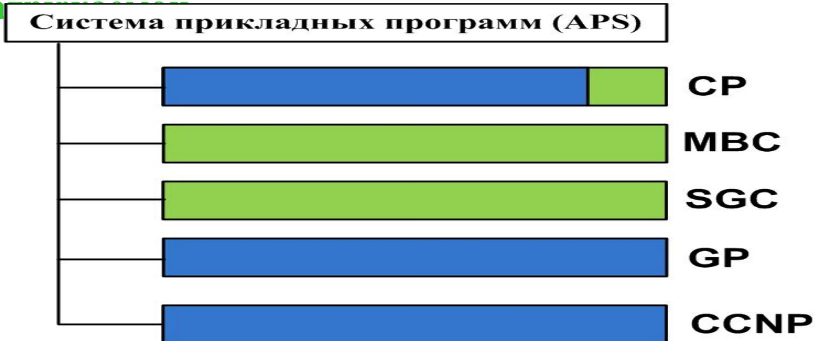
Архитектура ПО построена так, чтобы при частых технологических изменениях аппаратных средств изменялась только *минимальная часть программ*. Это достигается применением *принципа программных оболочек*.
