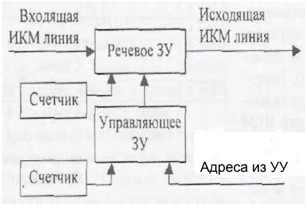
Для управления временным коммутатором программы вывода информации производят запись адресной информации в управляющее ЗУ.
