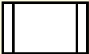
**ПРЕДОПРЕДЕЛЕННЫЙ ПРОЦЕСС (ПОДПРОГРАММА)** – использование ранее созданных и отдельно описанных алгоритмов или программ
