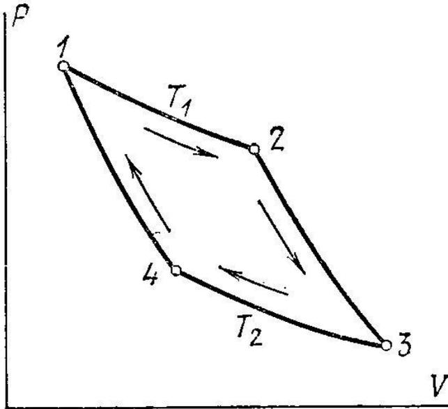
(1-2) – изотермическое расширение при  $T_1$ , получает от нагревателя  $Q_1$ ;
